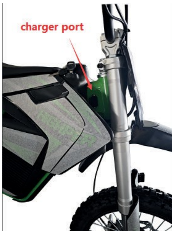
Gniazdo ładowania znajduje się po prawej stronie ramy.
